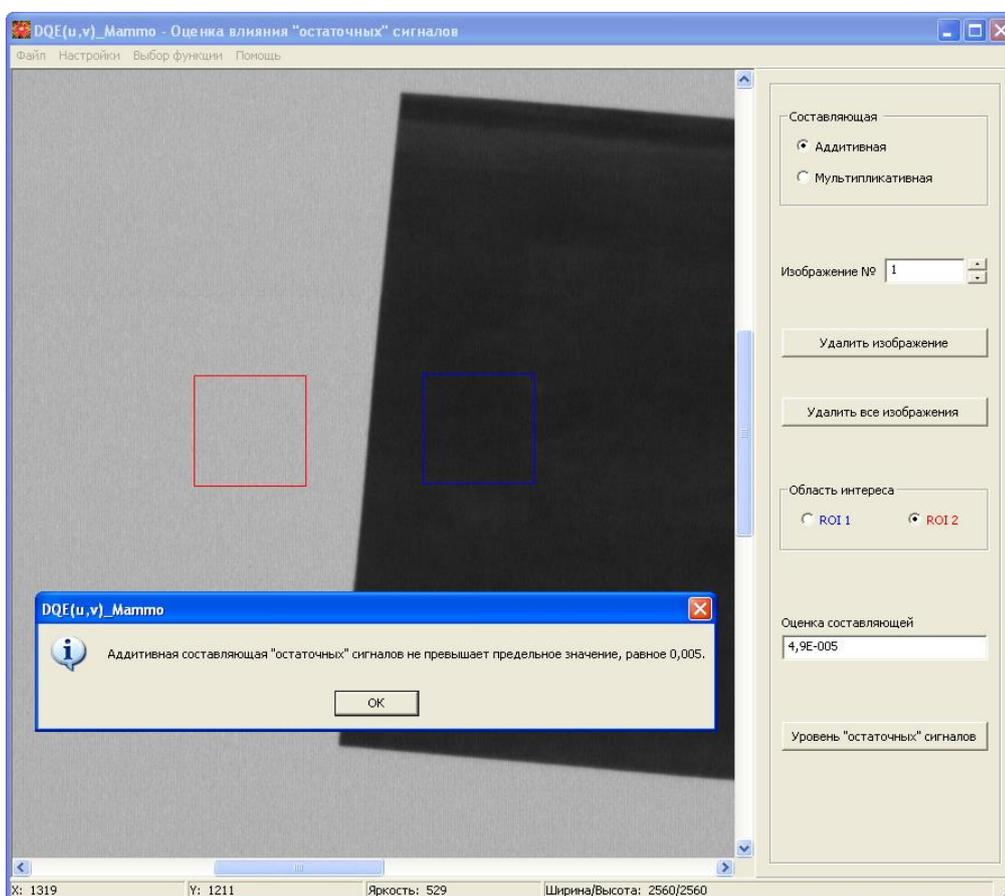
Рис. 3.2. Оценка аддитивной составляющей «остаточных» сигналов.
