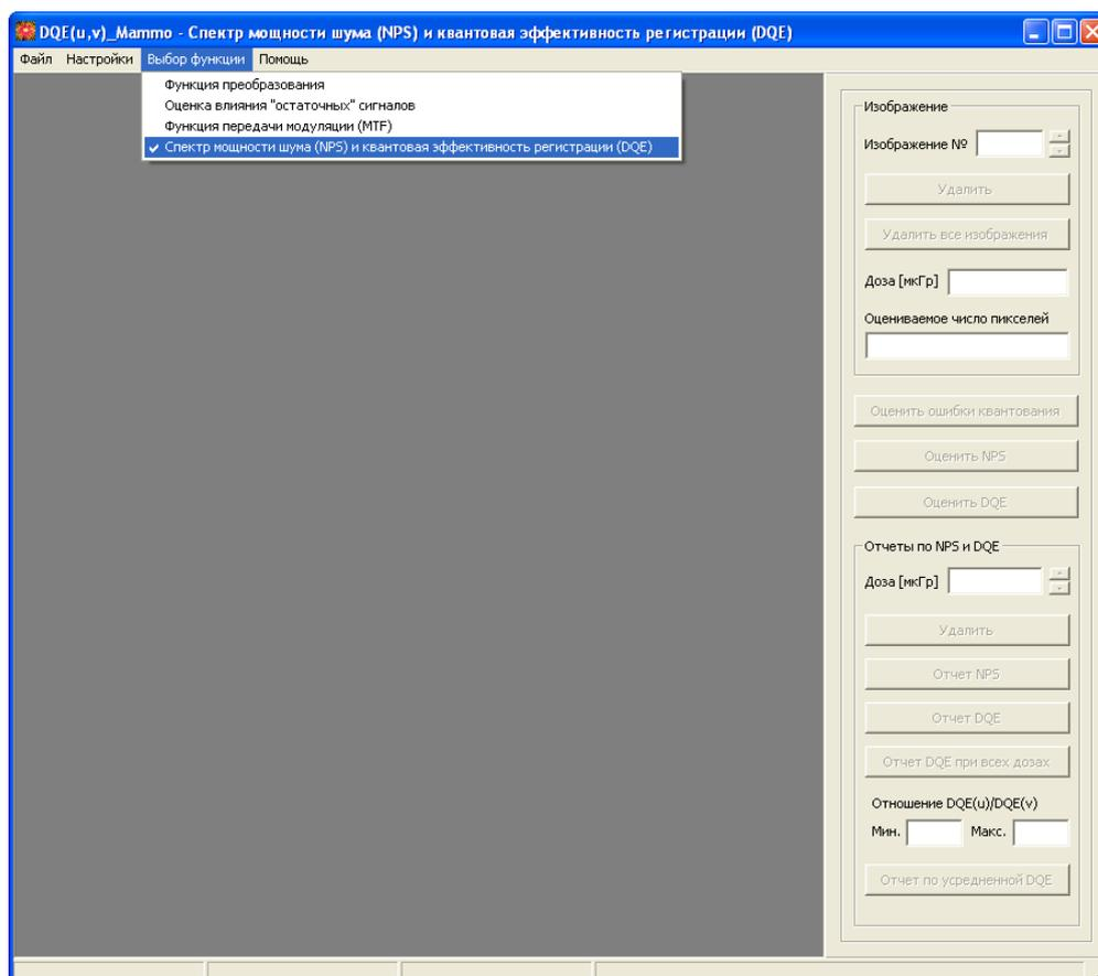
Рис. 5.1. Окно для оценки ошибок квантования, спектра мощности шума (NPS) и квантовой эффективности регистрации (DQE).
